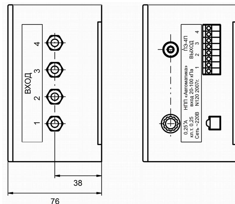
Рисунок 2 (окончание)- Габаритные размеры ПД-1Э со штуцером М20×1,5
