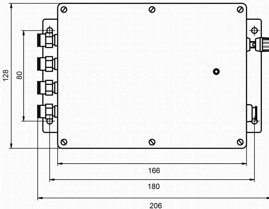
Рисунок 2 (начало)- Габаритные размеры ПД-1Э со штуцером М20×1,5
