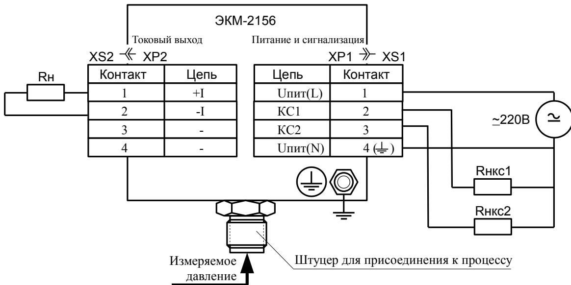
Рисунок Б.1 - Схема внешних соединений ЭКМ-2156
