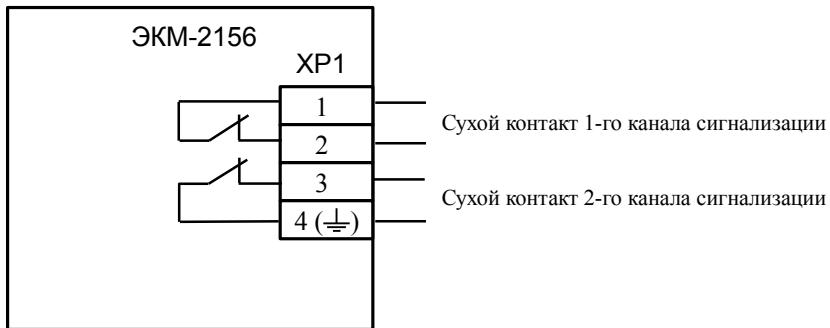
*а) для кода исполнения сигнализирующего устройства III Г*
