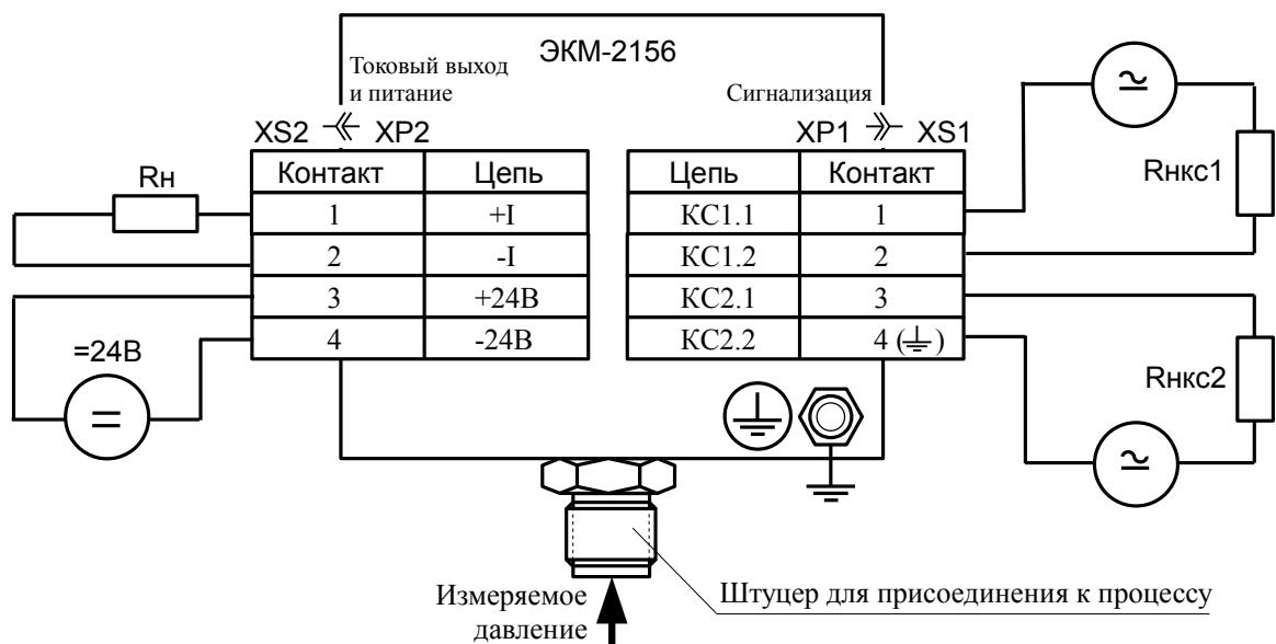
Рисунок Б.4 - Схема внешних соединений ЭКМ-2156 с напряжением питания постоянного тока  $= 24$  В, с гальванически развязанными цепями питания и коммутации
