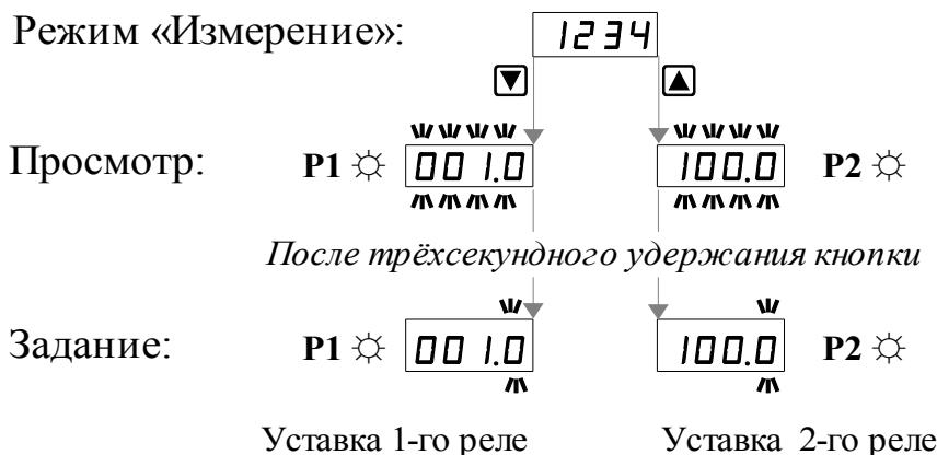
Рисунок 6 - Вход в режим «Уставки»,
