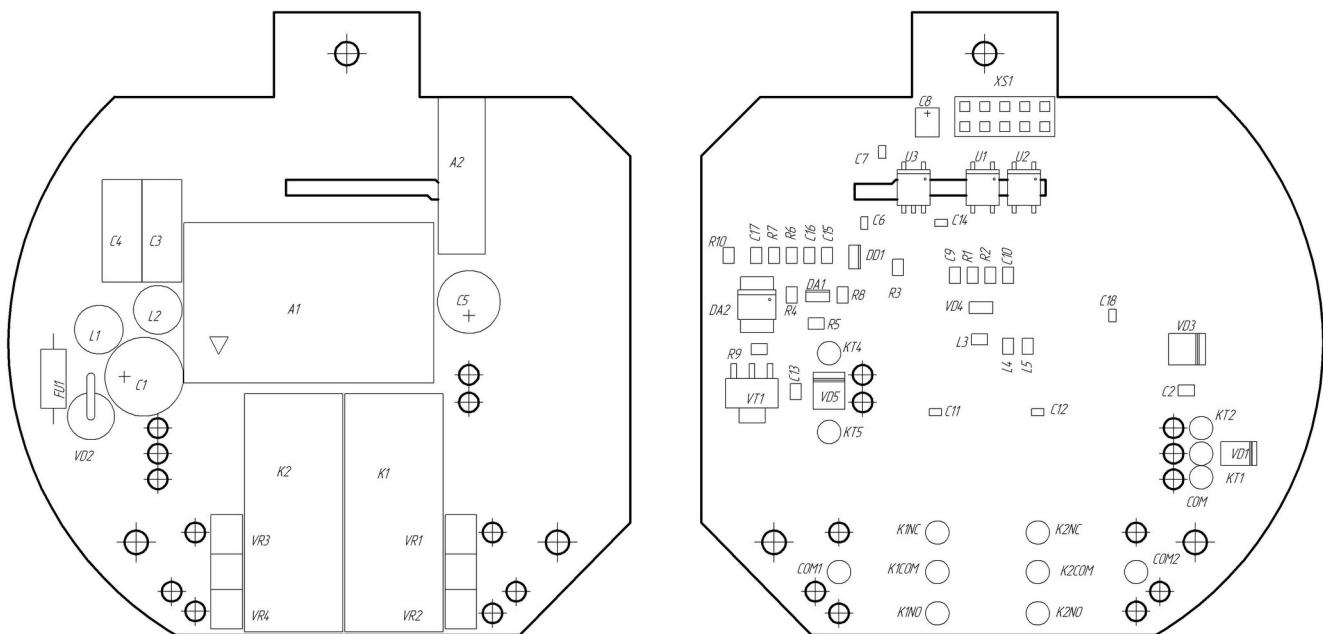
Рисунок 11 - Размещение элементов на плате питания 24 В
