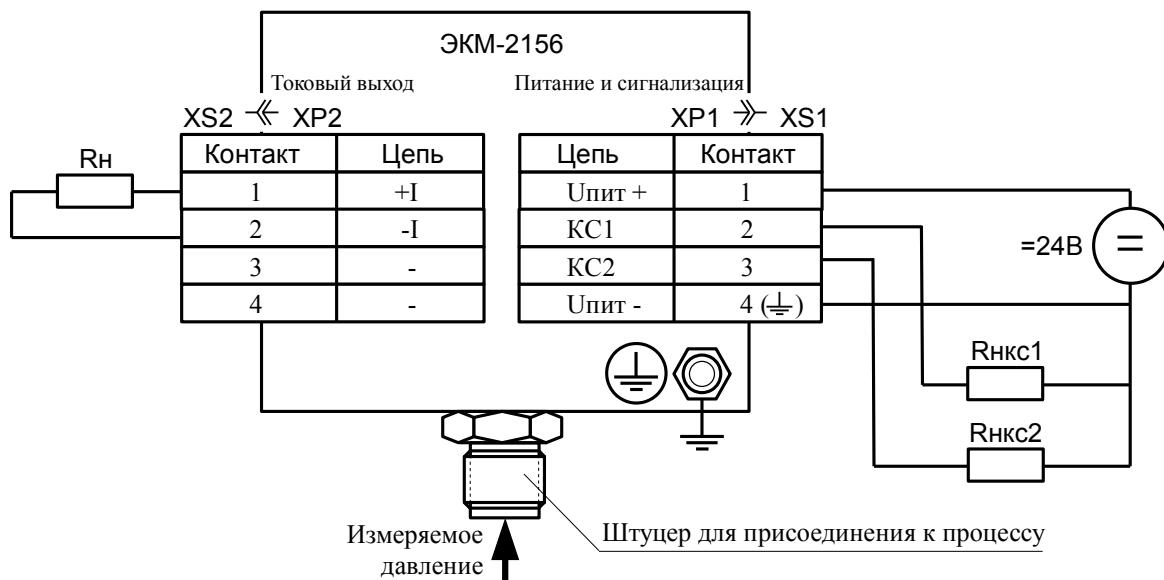
Рисунок Б.2 - Схема внешних соединений ЭКМ-2156
