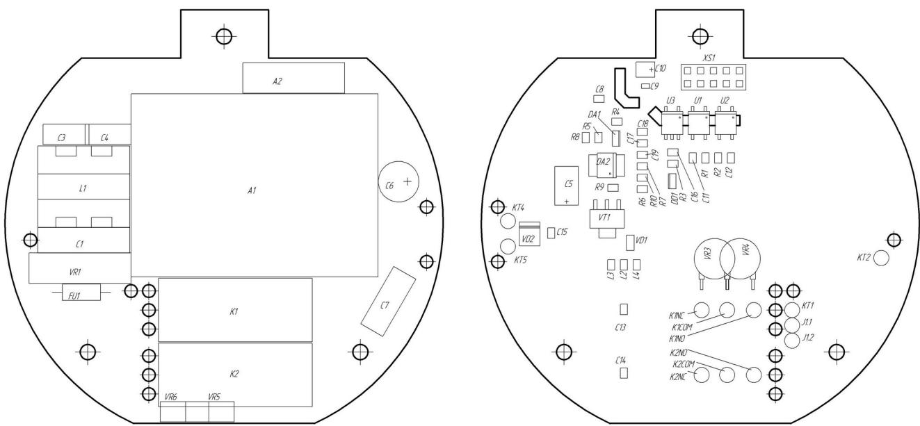
Рисунок 10 - Размещение элементов на плате питания 220 В
