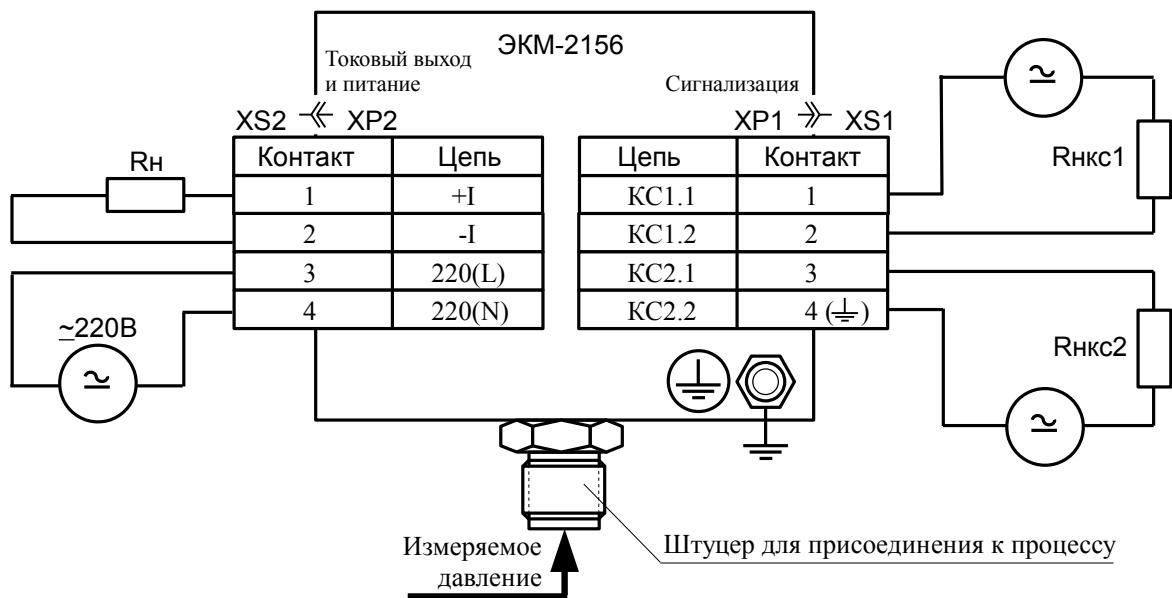
Рисунок Б.3 - Схема внешних соединений ЭКМ-2156 с напряжением питания  $\sim 220$  В переменного тока или  $= 220$  В постоянного тока, с гальванически развязанными цепями питания и коммутации
