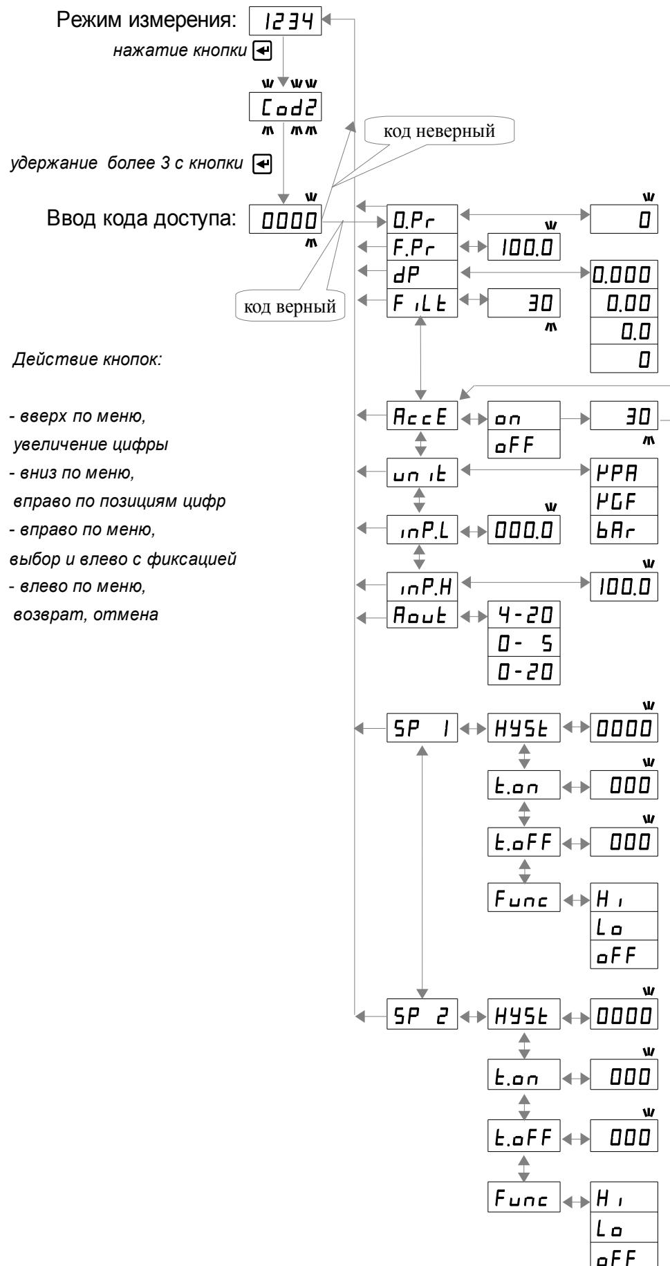
Рисунок 8 - Режим «Конфигурирование»
